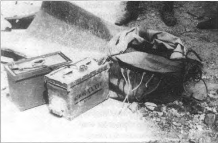
Wasserdichter Gummisack mit fünf Zündleitungen und bereits ausgebautem Funkempfänger (links) und Batterie mit Stromkabel (rechts). Sackverschluß mit Zugsünder zusätzlich gesichert.
